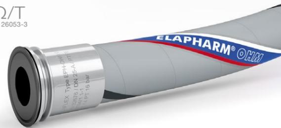
**Innen:** Teflon® PTFE schwarz, fest mit dem Druckträger verbunden, elektrisch leitfähig, nahtlos glatt, FDA-konform\*)
