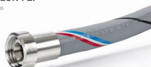
Universalschlauch mit nahtloser, transparenter Innenschicht aus Teflon® FEP. Geeignet für alle gebräuchlichen Medien bis +100°C, kurzzeitig bis +130°C (medienabhängig).
