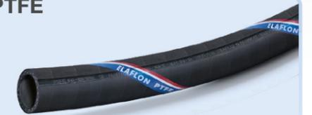
Der Star unter den EN 12115 'Ω/T' Schläuchen: Leitfähige, nahtlose Innenschicht aus Teflon® PTFE, für alle gebräuchlichen Medien bis +150°C (medienabhängig). FDA- und USP Class VI-konform.
