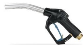
Korrosionsfeste Zapfventile mit automatischer Abschaltung. Abgabeleistung bis 60 l/min. Innenteile aus Edelstahl, Dichtungen Teflon®.
