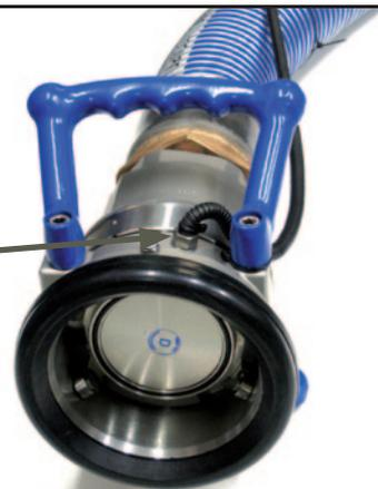
Der Sensor erkennt den Kupplungszustand des Mutterteils – z.B. wenn ein System nur im gekuppelten Zustand (offen) eine Befüllung zulassen soll.
