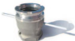
Werkzeug zur Entleerung von Mutterteilen
