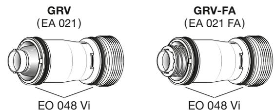
Das **GRV-FA** (EA 021 FA) wird einbaufertig, vorjustiert und auf Gasdichtigkeit geprüft geliefert.
