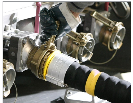
LTW Leicht-Tankwagenschläuche: für E 85 und Biodiesel ab B10 geeignet.
