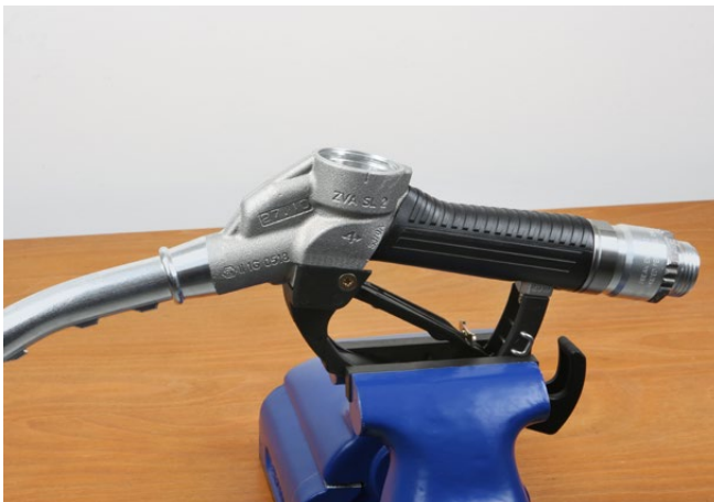
Zapfventil leicht geneigt im Schraubstock einspannen. Clamp nozzle into vice and tilt as shown.
