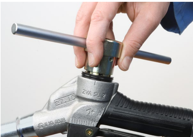
Mit Montagewerkzeug EW7 Einschraubdeckel einschrauben und handfest anziehen. Use tool EW7 to hand-tighten the cap until you feel resistance.
