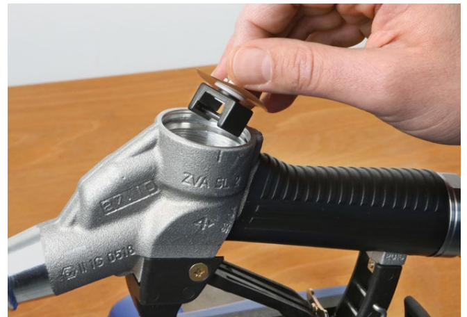
Membrangarnitur EA 151 TD in Zapfventil einsetzen. Insert diaphragm assembly EA 151 TD into nozzle.
