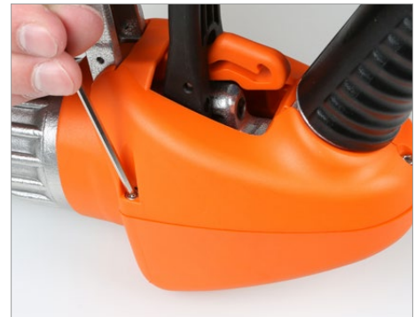
Schrauben EB 870 einlegen (3 Stück) und mit Sechskantschlüssel festschrauben. Fix parts with 3 screws EB 870 and hexagonal head wrench.
