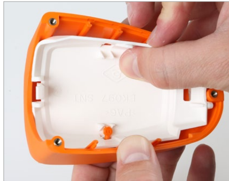
Schutzüberzug Oberenteil und Werbefläche EK 097 SNT miteinander verbinden: Dafür die Haken durch die Öffnungen der Werbefläche führen und einrasten. Connect top scuffguard and nozzle talker EK 097 SNT: Push the hooks through the openings in the nozzle talker and snap them in.
