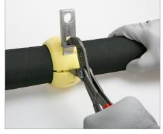
Verbindung des EW 39 durch Zusammendrücken der Zange lösen. Schlauch dazu ggf. etwas anheben.
