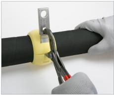
Die Zange in die untere Öffnung des EW39 und in die Kerbe der Gleitschale mit Federverbindung einsetzen.
