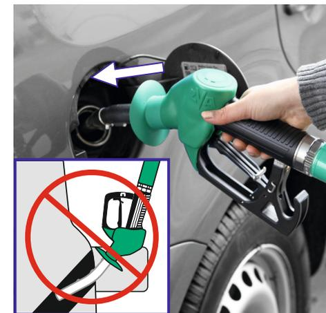
... und einführen, bis es sicher im Einfüllstutzen steckt. Möglichst nicht 'über Kopf' tanken.
