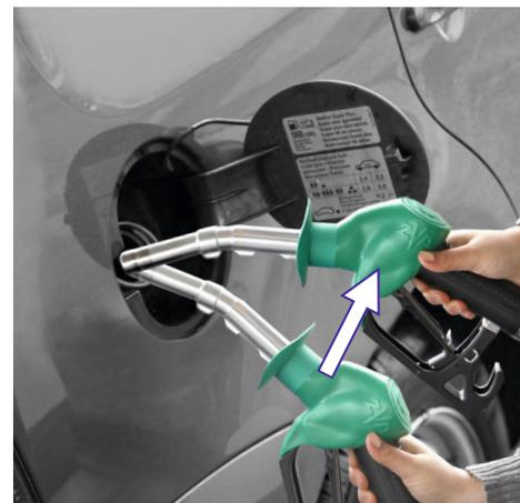
Wenn Auslaufrohrende nahe beim Einfüllstutzen, Zapfventil wie gezeigt neigen ...
