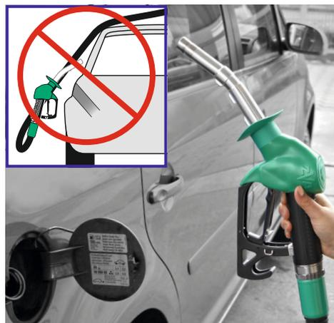
Tanköffnung sollte möglichst auf Zapfsäulenseite sein. Zapfventil mit Auslaufrohrende oben zum Einfüllstutzen des Fahrzeugs führen.
