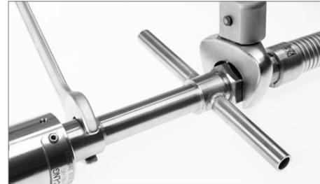
Schlauchleitung anschrauben. Das vom Hersteller empfohlene Drehmoment für Schlauchleitungen einhalten. Bei ELAFLEX Schlauchleitungen für LNG 13: 60 Nm, für LNG 25: 150 Nm.
