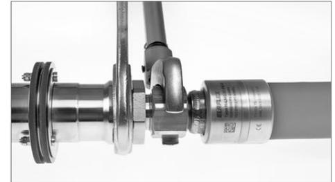
**Hinweis:** Beim **Anschrauben an Abreißkupplung** muss die Gegenseite unbedingt gekontert werden, um eine Vorschädigung der **Bruchbolzen EB 544** auszuschließen.
