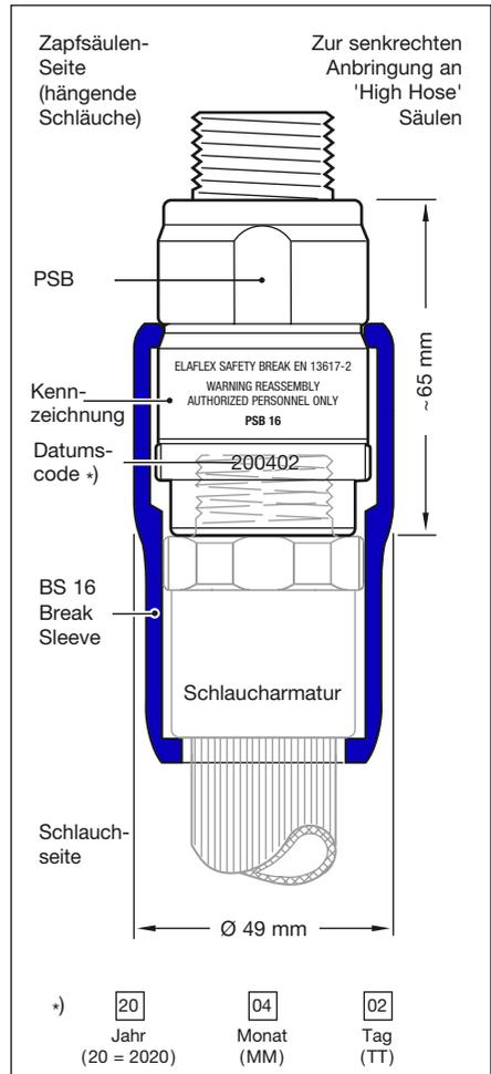
Schlaucharmatur in das **PSB** Gewinde schrauben. Anschließend prüfen, ob alle Verbindungen dicht sind.
