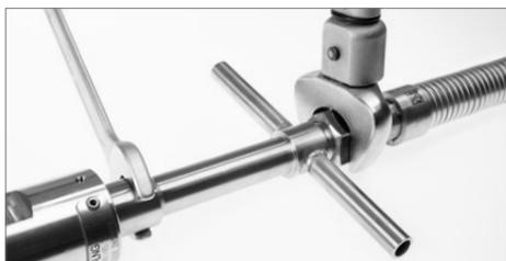
Schlauchleitung an Entlüftungskupplung anschrauben. Das vom Hersteller empfohlene Drehmoment für Schlauchleitungen einhalten. Elaflex Schlauchleitungen LNG 13: 60 Nm. **Kein Einsatz von Zangen oder Rohrzan-**
