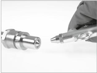
Mit Druckluft den Ventilsitz reinigen. Feuchtigkeit, Eis und Schmutz müssen vollständig entfernt werden.
