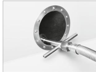
Entlüftungskupplung wieder in Vorrichtung der Zapfsäule einhängen.
