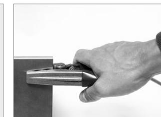
Erdungskabel von der Station an den LNG-Tank oder das Fahrzeug anschließen.
