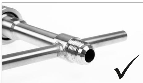
Dichtflächen der Verbindung der Entlüftungskupplung als auch der Schlauchleitung prüfen.
