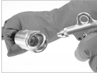
Mit Druckluft nun die Entlüftungskupplung reinigen. Feuchtigkeit, Eis und Schmutz vollständig entfernen, bevor die Entlüftungskupplung am Ventilsitz gekuppelt wird. Auf optische Beschädigungen, übermäßigen Verschleiß und Undichtigkeit prüfen.
