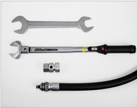
Werkzeuge und COAX-Zubehör: Doppelpmaulschlüssel EW M 36/41, Drehmomentschlüssel mit Schlüsselweite 36, ZAF 3.1 und COAX-Schlauchleitung Tools and COAX accessories: Double head wrench EW M 36/41, torque wrench size 36, ZAF 3.1 and COAX hose assembly
