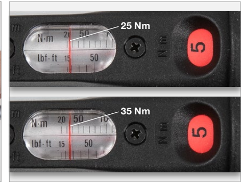
Das Drehmoment muss zwischen 25 Nm und 35 Nm liegen. Torque limit thereby shall be between 25 Nm and 35 Nm.
