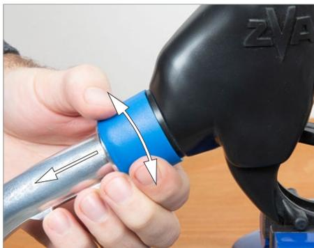
Com um movimento rotativo, remova a tampa do produto EK 043 (ou proteção contra respingos EK 652) em direção à ponta do bico.
