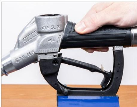
Segure a proteção em uma morça e insira o corpo do bico nele. Verifique se os parafusos do EB 235 estão posicionados corretamente.
