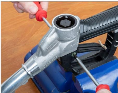
Solte os parafusos de proteção EB 438.1 com as chaves de fenda.
