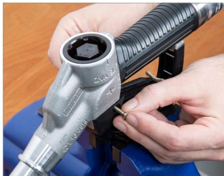
Insira o parafuso de proteção EB 438.1.
