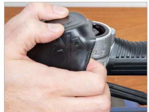
Coloque os dedos sob o protetor EK 044 e puxe-o em direção à ponta do bico para removê-lo.
