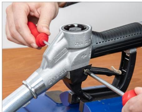
Aparafuse o conjunto de parafusos de proteção com as chaves de fenda.
