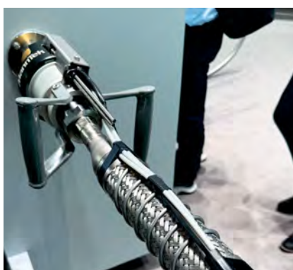
Die N-LH2-P – ein pneumatisches Lkw-Zapfventil mit Doppel-Schlauchpaket
