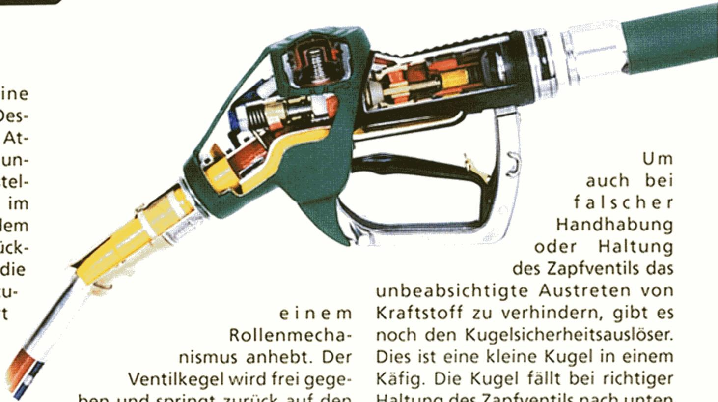
einem Rollenmechanismus anhebt. Der Ventilkegel wird freigegeben und springt zurück auf den Ventilsitz. Die Kraftstoffleitung ist verschlossen.
