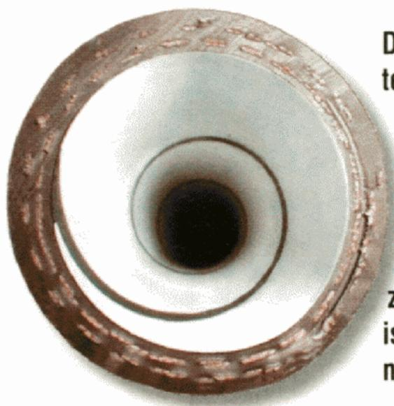
Die mit Ruß versetzte schwarze Leitspirale in der Innenauskleidung der so genannten OHM-Schläuche bedeckt nur etwa fünf Prozent der Fläche und ist deshalb praktisch nicht ausfärbend.
