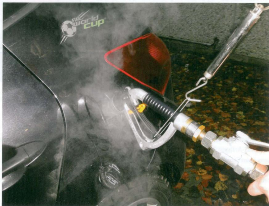
Enorme Gaswolken bei der Entspannung der Zapfpistole gehören bei neueren Produkten der Vergangenheit an.
