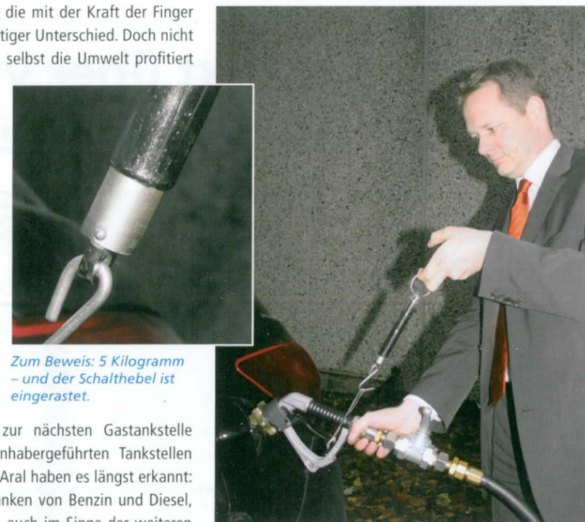
Zum Beweis: 5 Kilogramm – und der Schalthebel ist eingerastet.
