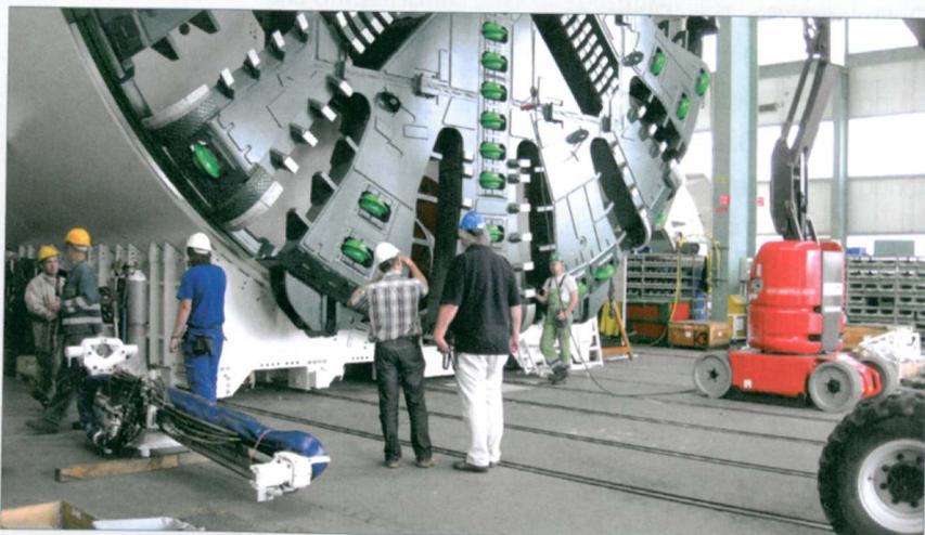
Abb. 1: Untere Hälfte eines Bohrkopfs einer Maschine eines weltweit tätigen Herstellers aus Schwanau im Bau.
