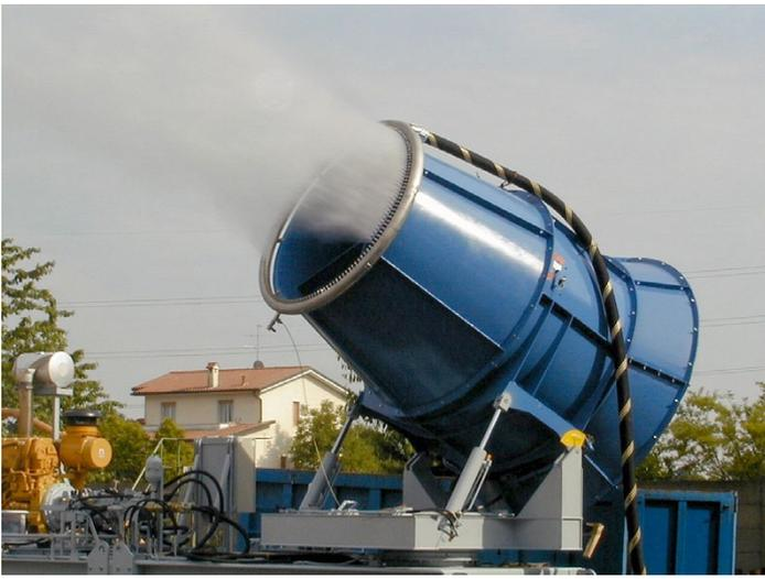
HD 100 Neon Spirale / große Aerosol-Kanone zur Staubvermeidung in Bergbau und bei Gebäude-Abriß - Ecology SRL, Italien
