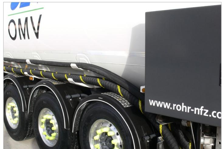
LTX 80 Tankwagen-Leichtschlauch für Schwerkraft-
