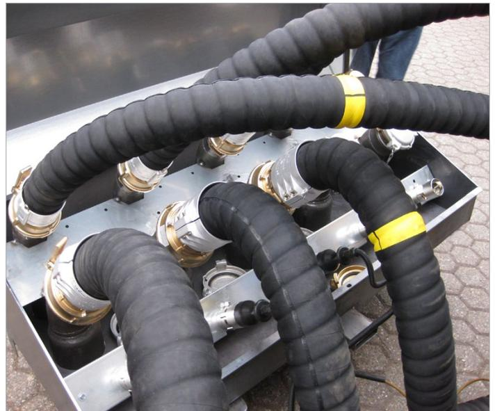
LTW Schlauchleitungen / Tankwagenentladung Tankstelle mit im Fahrzeug quer aufbewahrten
