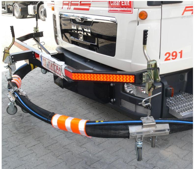
HD 100 C und HD 10 C / Dispenserfahrzeug / Der kleine Schlauch dient als Fühlerleitung - Rohr, Deutschland
