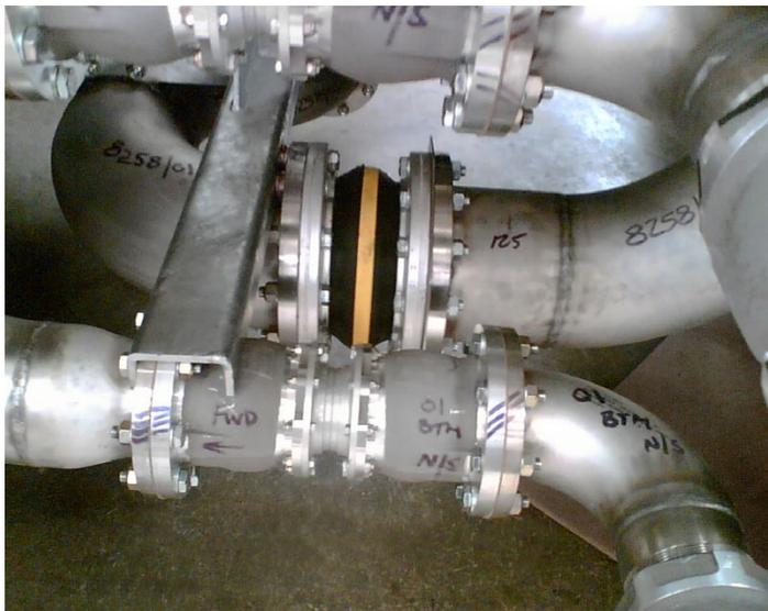
ERV-G TW im Leitungssystem eines Tankwagens / während der Produktion - Fluid Transfer, UK
