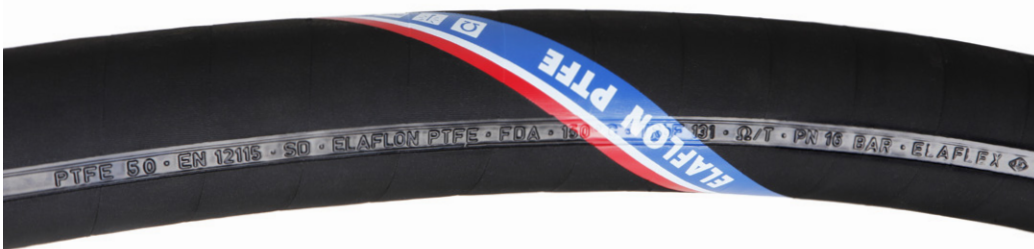
Beispiel ELAFLEX PTFE - max. 10^6 Ohm Widerstand zwischen den Armaturen - max. 10^9 Ohm durch die Schlauchwand. Nach EN 12115 bislang klassifiziert als Ω - Schlauch, nach EN 12115 : 2011 jetzt ein Ω/T - Schlauch.
