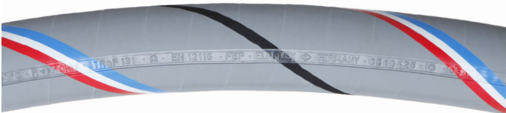
Beispiel ELAFLEX PLUS FEP - max. 10^6 Ohm Widerstand zwischen den Armaturen - nicht leitfähig durch die Schlauchwand. Nach EN 12115 bislang klassifiziert als M - Schlauch, nach EN 12115 : 2011 jetzt ein Ω - Schlauch.
