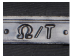
neue Ω/T - Kennzeichnung: Schlauch ist geeignet für explosionsfähige Gemische und für explosionsgefährdete Bereiche
