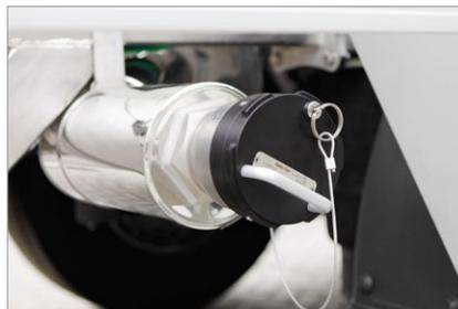
DDC-Kappe aus Aluminium mit Druckentlastung nach ADR
