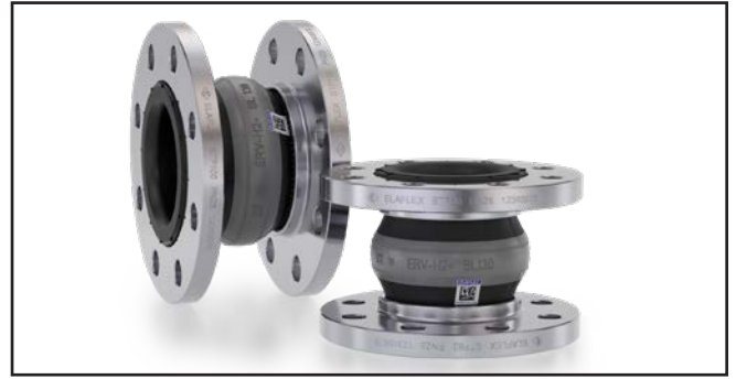
ERV-H2+ Gummikompensatoren mit extrem niedriger Permeationsrate für den Transfer von Wasserstoff, Methan oder 'Hythan' von ELAFLEX, auf Anfrage auch mit PTFE Liner.
