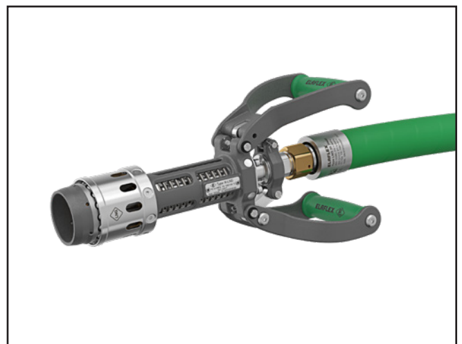
N-LNG-Zapfventil zum Betanken von Schwerlast-fahrzeugen (LKW) mit einer Betankungsschnittstelle gemäß EN ISO 12617. Durchflussmenge bis zu 190 l/min (50 GPM). Maximaler Betriebsdruck 34 bar, Medientemperatur bis zu -196 °C.
