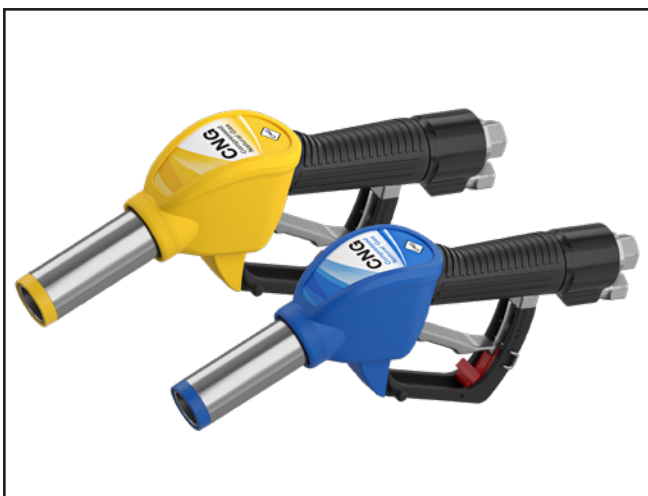
Das N-CNG-Zapfventil ist als N-CNG P30 für Nenn-drücke bis zu 207 bar / 3.000 psi (EU-Norm, blau) und als N-CNG P36 für bis zu 250 bar / 3.600 psi (US-Norm, gelb) lieferbar.
